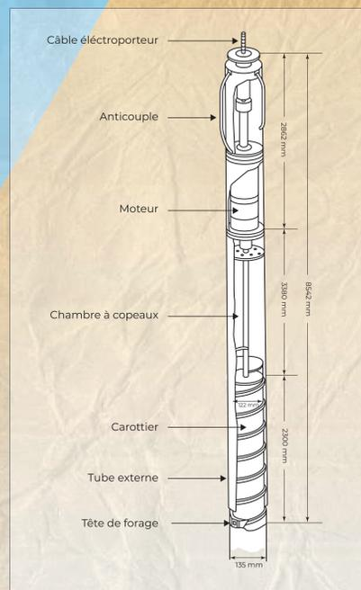
Schéma d'un carottier grande profondeur
